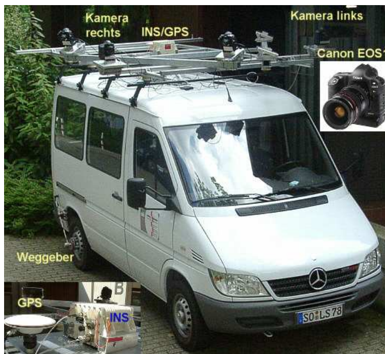
Abb. 3: Das Vermessungsfahrzeug, hier mit 4 Kameras vom Typ Canon EOS1 dem Inertialsystem (INS) LCI-6x und der GPS-Antenne auf dem Dach und den beiden Weggebern (Odometer) an den Hinterräder
