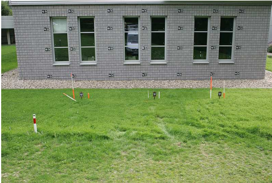
Abb. 4: Das Testfeld mit den koordinatenmäßig bekannten kodierten Zielmarken (System ETRS 89)
