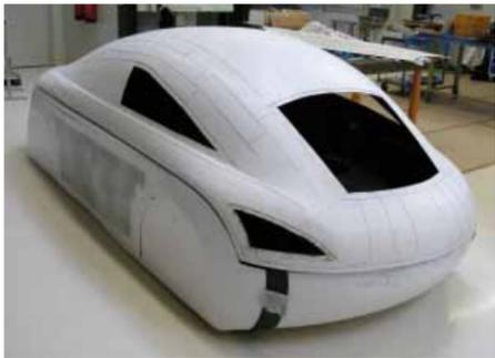
An der Kohlefaser-Hülle ist die Form des BOcruisers bereits gut erkennbar.
