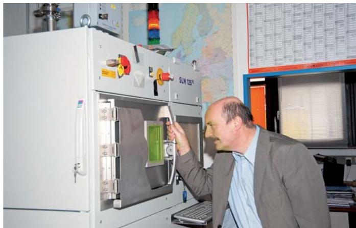
Ein wichtige Gerät im UTZ soll der 3D-Lasersinter sein, mit dem auch Prototypen aus Metall erstellt werden können. Prof. Radermacher wirft einen Blick durch das Sichtfenster der Maschine.
