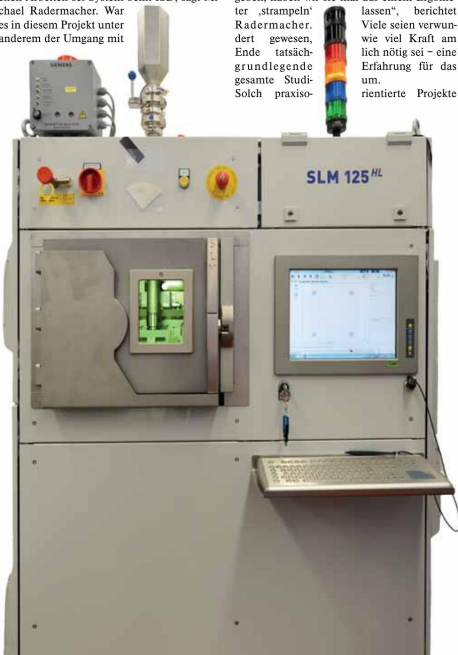
Ein ganz besonderer „Schrank“: Die Selektive Laser Melting (SLM) Anlage im Universaltechnikzentrum kann auf der Basis von 3D-CAD-Daten hochwertige metallische Bauteile aus Stahl, Kobalt-Chrom, Inconel, Aluminium, Titan oder sogar Gold „drucken“.
