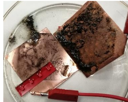
Abbildung 6: Versuchsaufbau und dunkle Wolke Abbildung 7: Entstandener „Kolloidschlamm“
