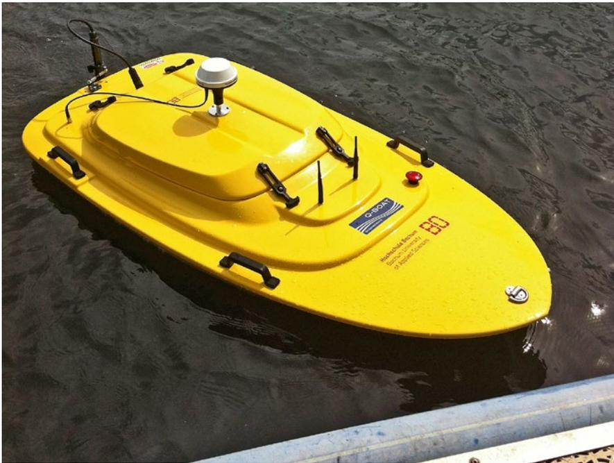
Mobiles ADCP-Messsystem River Surveyor M9 mit Geräteträger Q-Boat 1800D. © LWH
