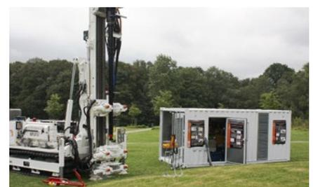
**Bild 1:** F&E-Bohranlage BO.REX mit containerisierter Hochleistungsplungerpumpe. © GZB
