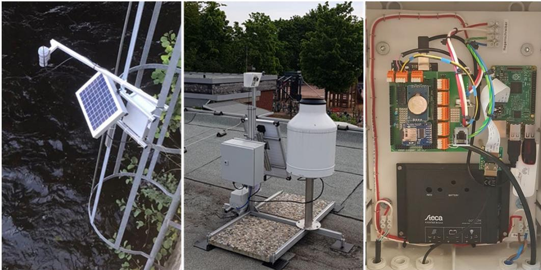
Abbildung 1: Anwendungsvarianten des Datenlogger-Konzeptes im Feldeinsatz zur Wasserstandsmessung (links) mittels Ultraschall-Füllstandsensor sowie für die Niederschlagsmessung mit angeschlossener Kamera zur Messstellenüberwachung (Mitte); rechts: Blick in den Schaltschrank der Niederschlagsvariante
