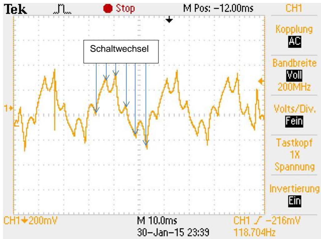
Abbildung 33 Strom bei  $n_{max} = 1300 \text{ min}^{-1}$
