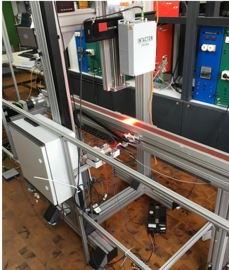
*Abbildung 1-1: Teststand für optische Geschwindigkeitssensoren*
