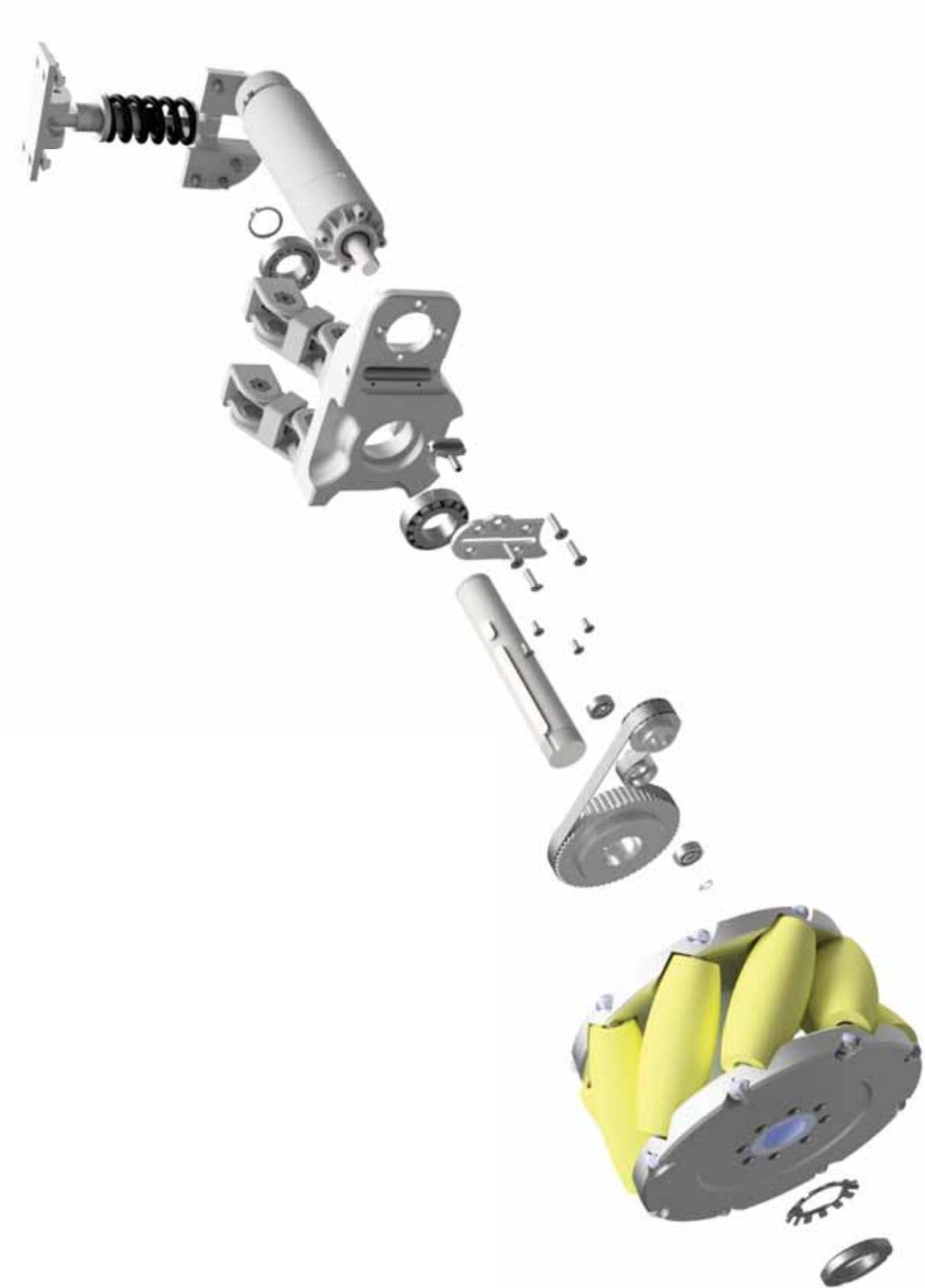
Abbildung 2.16: Antriebseinheit - Explosionszeichnung
