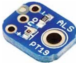
Abbildung 2.48: Anschlussplatine des Helligkeitssensors ALS-PT19-315C/L177/TR8 [1]
