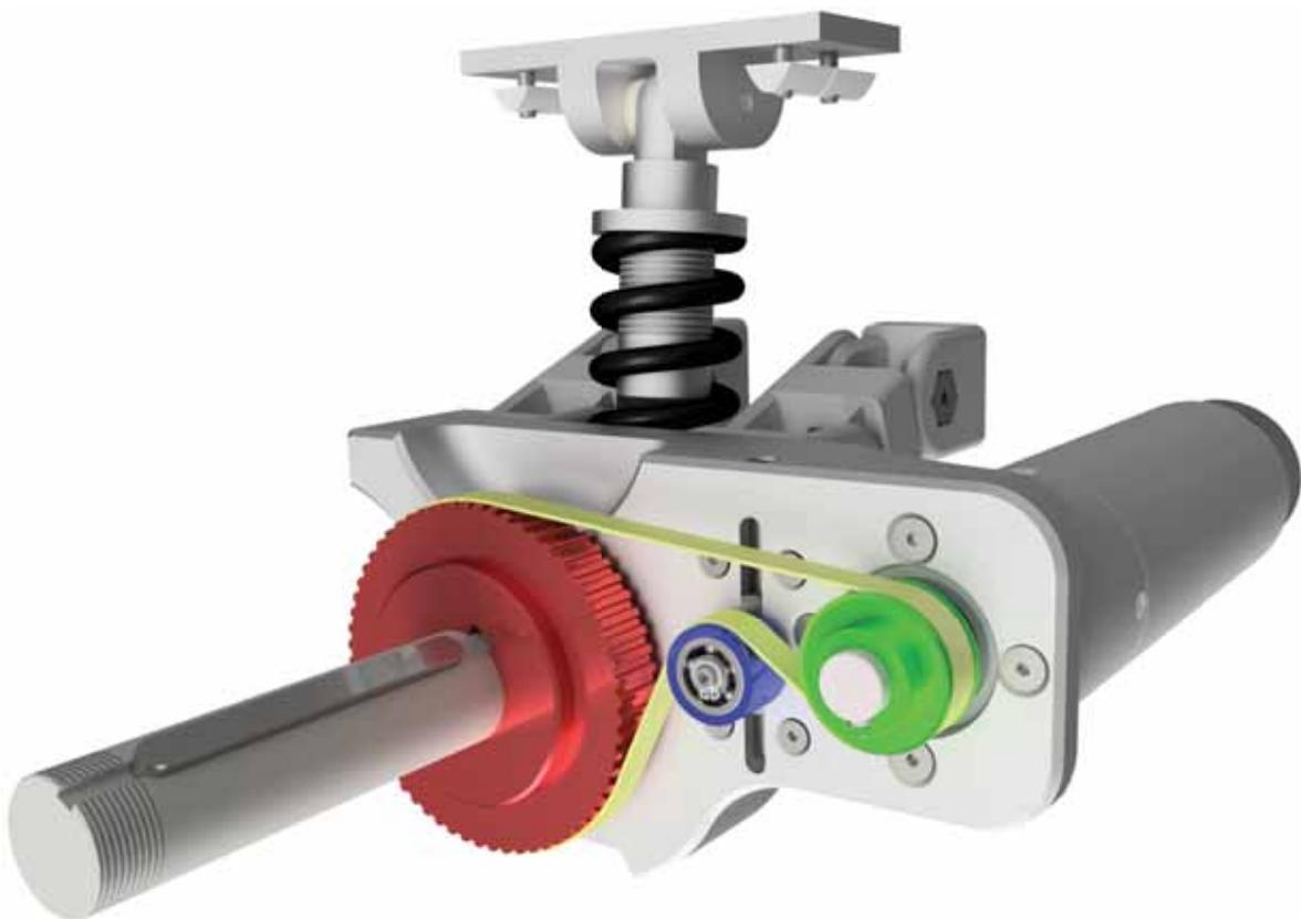
Abbildung 2.21: Zahnriemengetriebe - Primäre Riemenscheibe (grün), Sekundäre Riemenscheibe (rot), Spannvorrichtung (blau), Zahnriemen (gelb)
