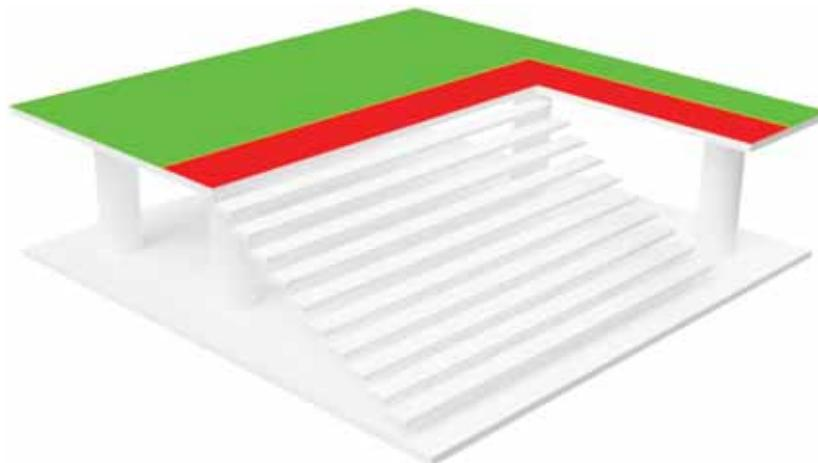
Abbildung 2.41: Sicherheitsbereiche - sicherer Bereich (grün), nicht sicherer Bereich (rot)
