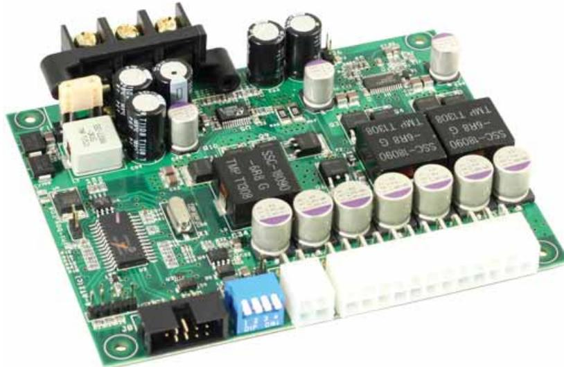
Abbildung 2.62: ATX-Netzteil der Hauptsteuerung [49]
