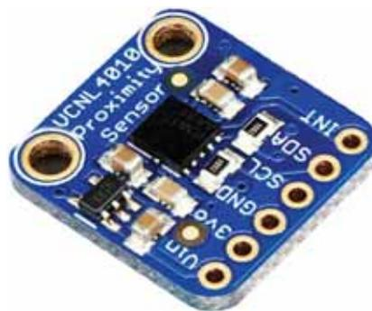
Abbildung 2.46: Anschlussplatine des Infrarotsensors VCNL4010 [4]
