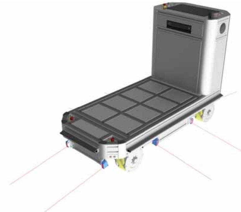
Abbildung 2.38: Treppenerkennung - Anordnung der Sensoren
