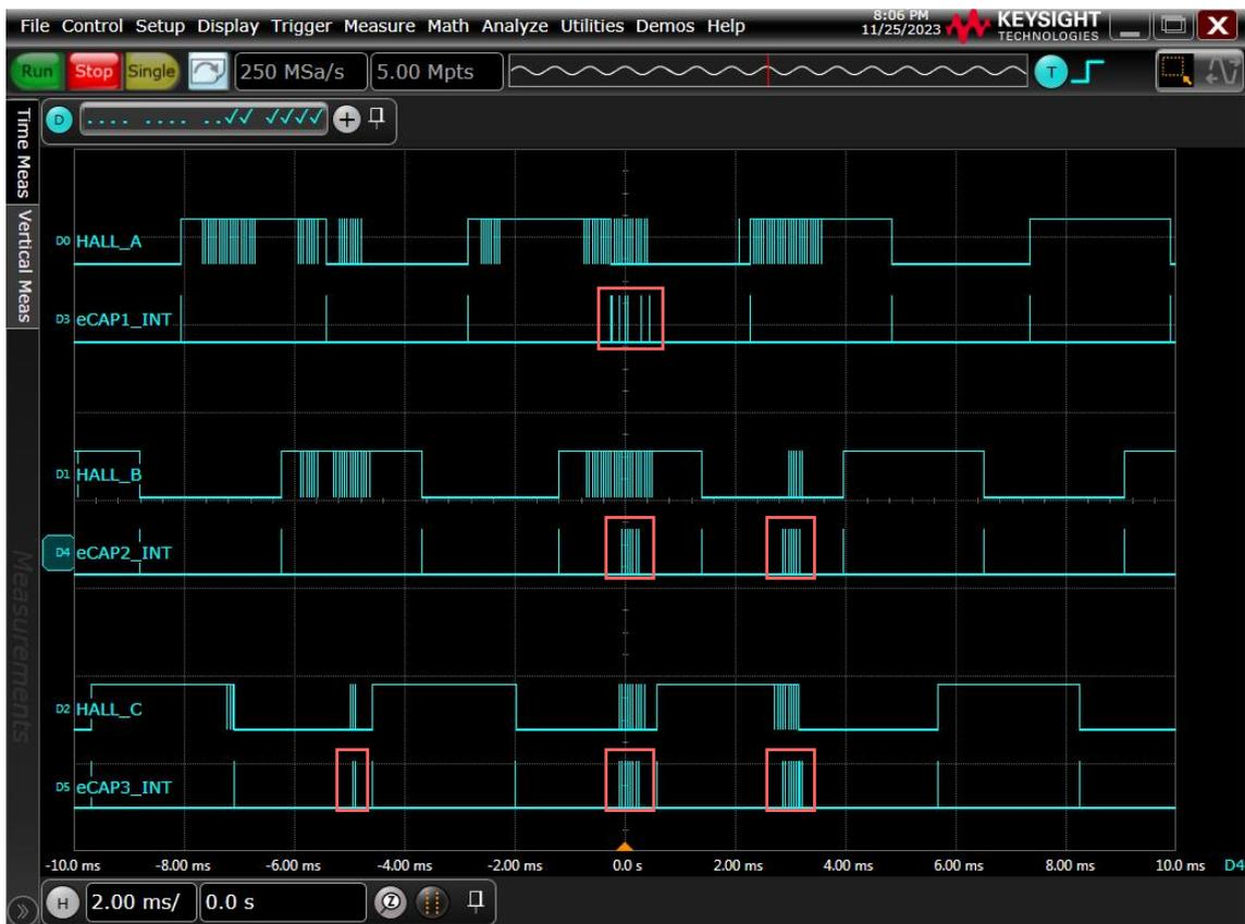
Abbildung 7.6: Übersicht der Hall-Signale mit den dazugehörigen eCAP-Interrupts
