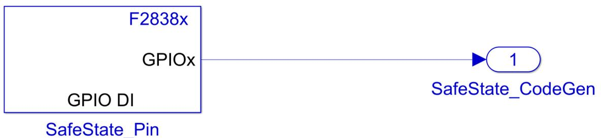
Abbildung 5.9: Implementierung des sicheren Zustands mit einem *GPIO Digital Input*-Block
