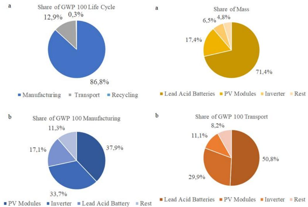
Abbildung 7: Links: (a) Gesamtmenge der GWP-Emissionen; (b) Anteil des GWP für das Don Bosco Mini Grid; Rechts: (a) Gesamtanteil des GWP für die zugehörige Masse; (b) Gesamtanteil des Verkehrs
