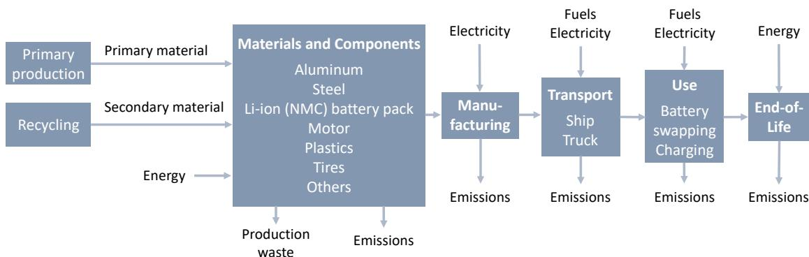
Abbildung 9: Systemgrenzdiagramm für die Ökobilanz von e-Mopeds in einem Sharing-System
