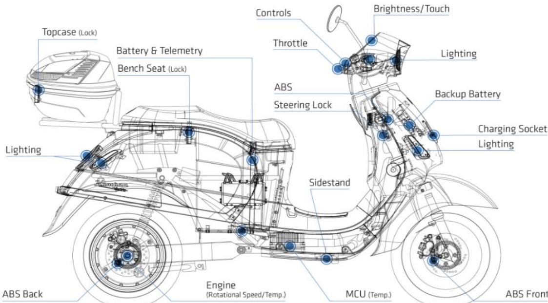
Abbildung 8: Technische Zeichnung des E-Mopeds Kumpan 1954, welches im MoNaL-Projekt verwendet wurde, bereitgestellt durch die e-bility GmbH
