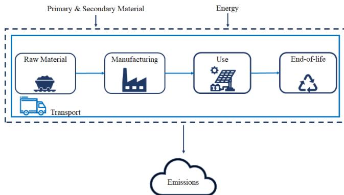
Abbildung 5: Systemgrenzdiagramm für die Ökobilanz des Mini Grid
