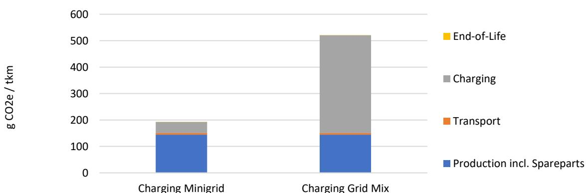
Abbildung 14: Lebenszyklus-THG-Emissionen pro Tonnenkilometer der in Ghana eingesetzten E-Lastenräder für verschiedene Szenarien
