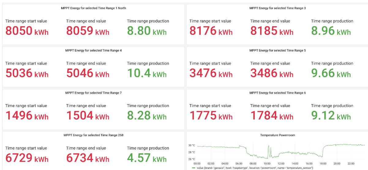
Abbildung 21: Von den im Power Room installierten Laderegeln erzeugte Leistung, am 5. August 2022
