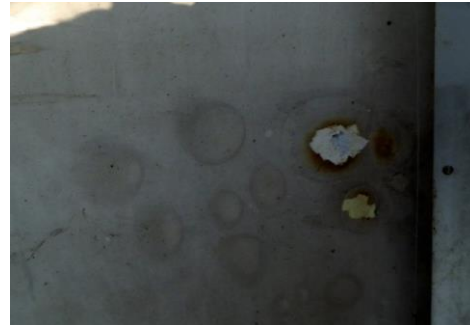
Abbildung 11: Löcher und Blasen auf der Rückseite (MoNaL Team, 2021)
