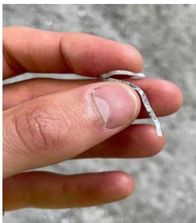
Abbildung 21: Stromschiene als Teil des geschredderten Materials (Bild: MoNaL-Team, 2022)
