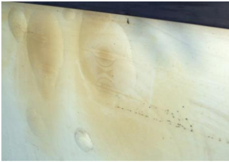
Abbildung 10: Blasen unter der Rückseitenfolie (MoNaL Team, 2021)
