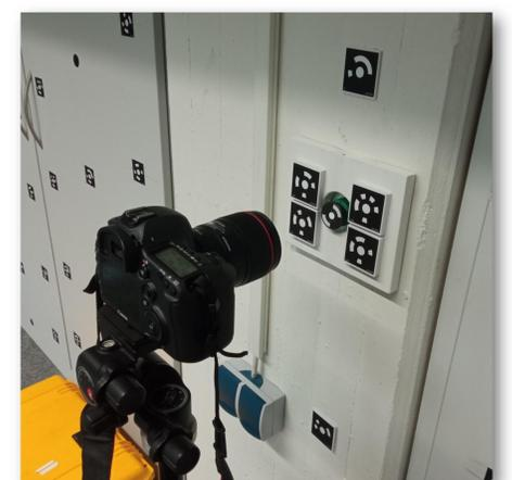
Versuchsaufbau zur Überprüfung der SM-Targets
