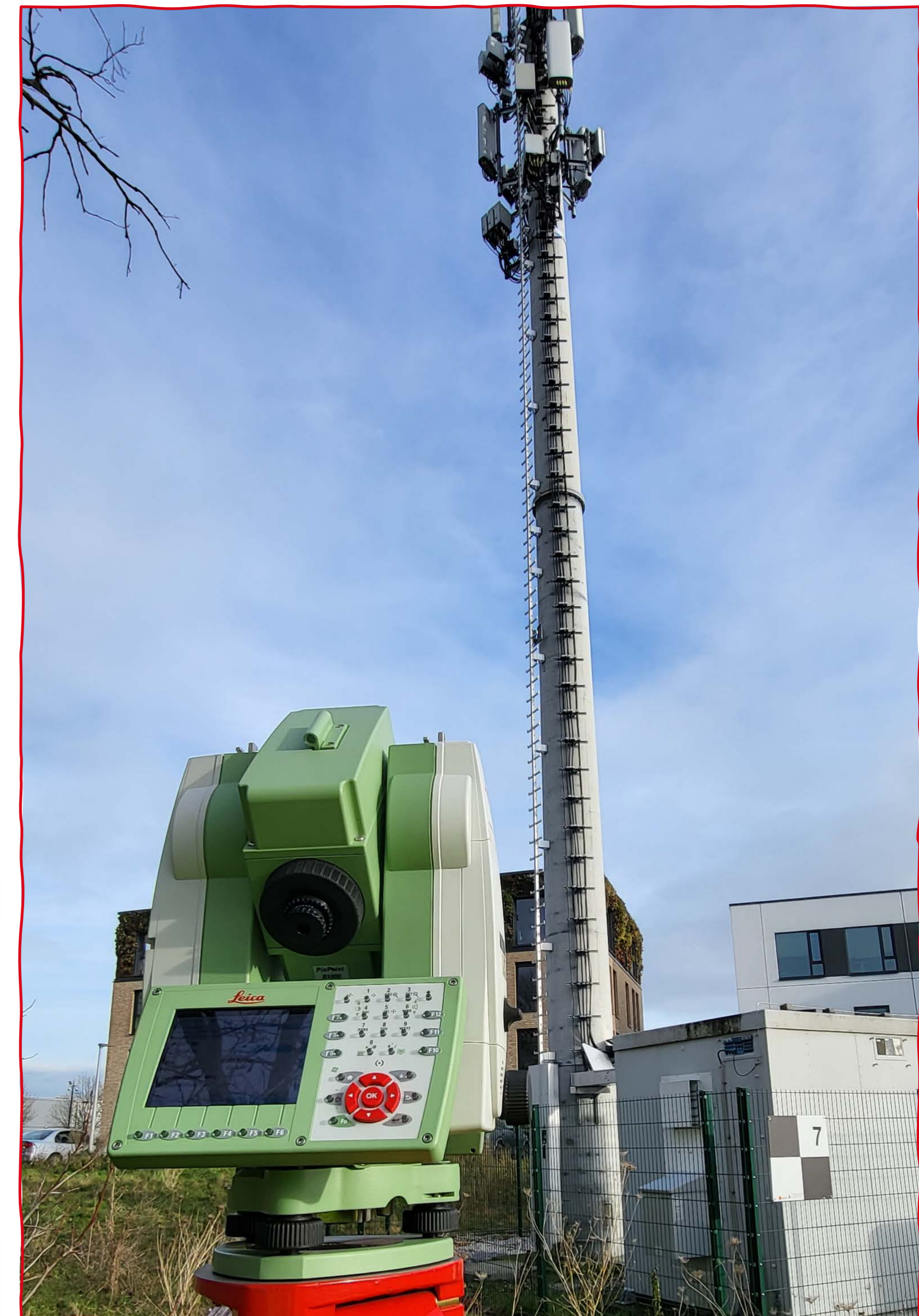
Einmessung der vertikal ausgerichteten Targets als Checkpoints für die Kontrolle der Auswertung
