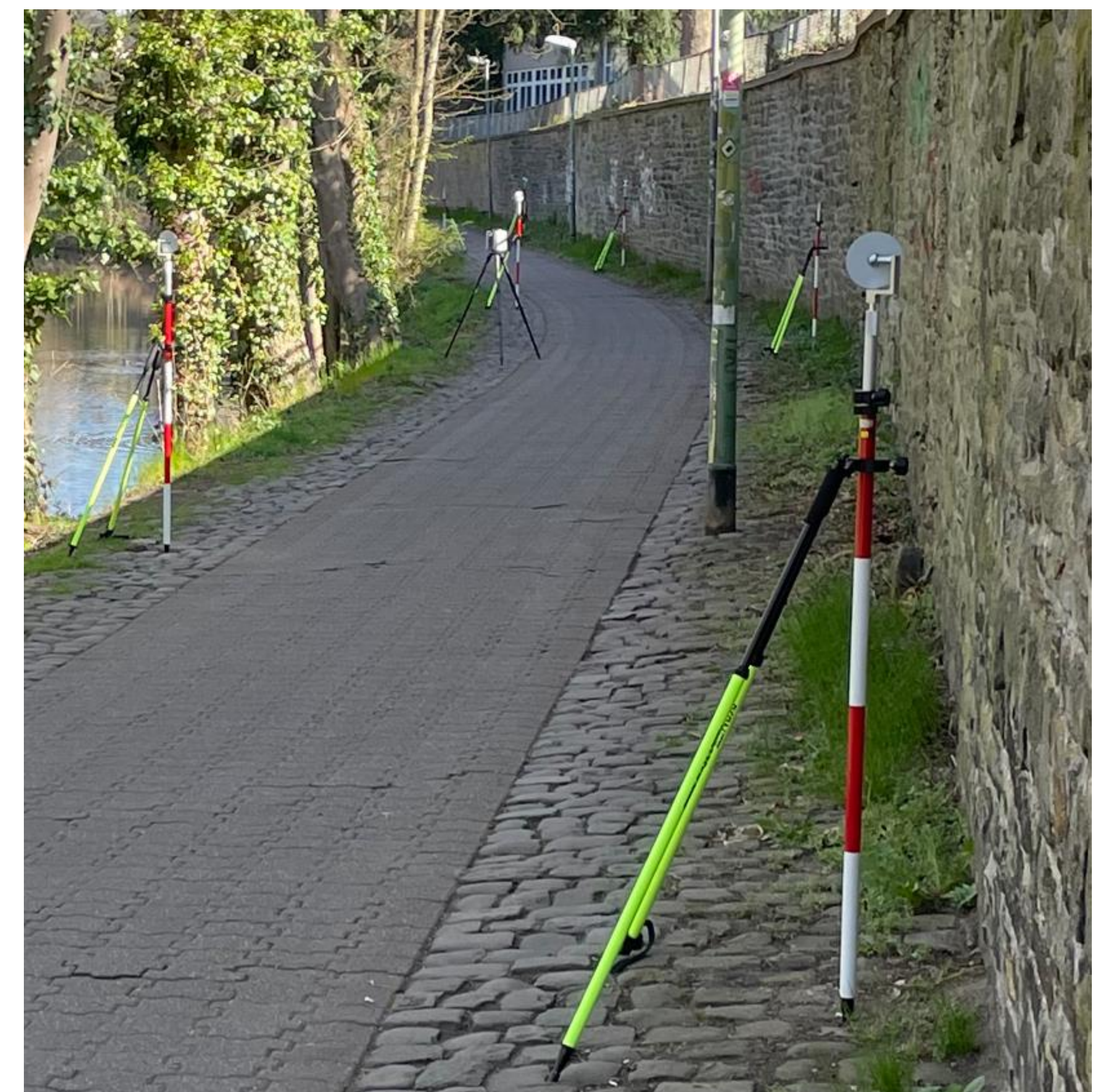
TLS-Aufnahme der Stützmauer (rechts) mit „Tilt and Turn“-Targets zur Erfassung der Geometrie
