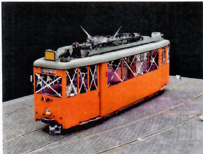
links: Abb. 5: texturiertes 3D-Modell (Laserscan und HDR-Fotos)
