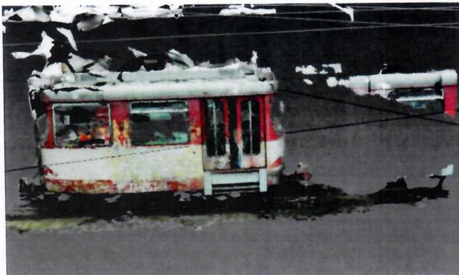
Abb. 8: Fehlerhaftes 3D-Modell des Wagens 3101 aus dem Programm „Meshroom“ (Freeware). Die Fahrköpfe wurden ohne das Mittelteil aneinander gerechnet, weitere Fahrzeugteile wurden nicht berücksichtigt.
