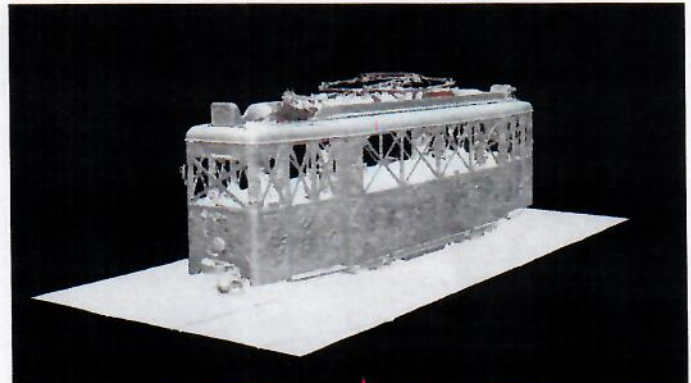
links: Abb. 5: texturiertes 3D-Modell (Laserscan und HDR-Fotos)
