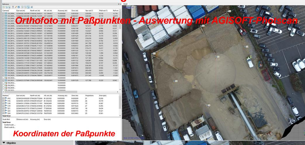
.... Box 1 482.78 ± 5.74 m Volumen des Schnitts:  $-0.03 \pm 0.03 \text{ m}^3$ Volumen der Füllung:  $482.75 \pm 5.77 \text{ m}^3$ Hilfe 211.74 ± 3.83 m Volumen des Schnitts: -17.85 ± 3.29 m3 Volumen der Füllung: 193.89 ± 7.12 m Hilfe .... Box 3 Volumen des Schnitts: 620.29 ± 6.94 m  $-0.05 \pm 0.04 \text{ m}^3$ Volumen der Füllung:  $620.25 \pm 6.98 \text{ m}^3$ Hilfe Box4 Volumen der Füllung:  $-0.00 \pm 0.01 \text{ m}^3$ 512.65 ± 5.98 m<sup>3</sup> Hilfe
