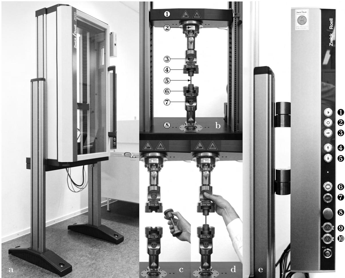
Abbildung 2.6: (a) Am Campus Velbert/Heiligenhaus verwendete Prüfmaschine ZWICK/ROELL Z020 TN. (b) Prüfraum ausgestattet für den Zugversuch. (c) Einsetzen der Probe inkl. Einsätzen. (d) Verspannen der Einsätze in den Schulterprobenhaltern. (e) Steuerung testControl II. Vergleiche Text für die Bezeichnung der Bauteile und Schalter.
