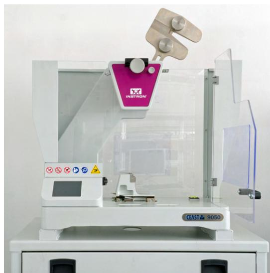
Abbildung 4.2: Versuchsanordnung und Versuchsdurchführung beim Kerbschlagbiegeversuch (links [MZ11]). Das im Praktikum am Campus Velbert/Heiligenhaus eingesetzte Pendelschlagwerk INSTRON CEAST 9050 mit 50 J Arbeitsvermögen (rechts).
