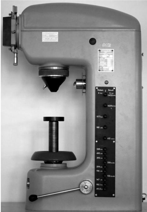
Abbildung 3.4: Am Campus Velbert/Heiligenhaus im Praktikum eingesetztes Härteprüfgerät HPO 250 des VEB Werkstoffprüfmaschinen Leipzig.
