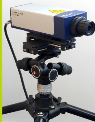
Berührungslose Messung dynamischer Weg-Zeit-Kennlinien erfolgt über ein Laser-Doppler-Vibrometer:
