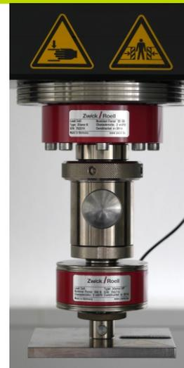
Für die Messung quasistatischer Kraft-Weg-Kennlinien verfügen wir über eine elektromechanische Zugprüfmaschine, Zwick/Roell 2020 TN. Mit zwei Kraftmessdosen kann im Bereich 0.4 N bis 20 kN mit Genauigkeitsklasse 0.5 (nach DIN EN ISO 7500-1) gemessen werden. Die Wegmessung entspricht im Bereich 0.5 mm bis 50 mm Genauigkeitsklasse 0.5 (nach DIN EN ISO 9513).
