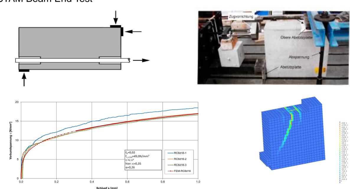
4.2 FEM-Analyse von nicht querkraftbewehrten Stahlbetonbauteilen mrotationssymmetrischen Hohlkörpern
