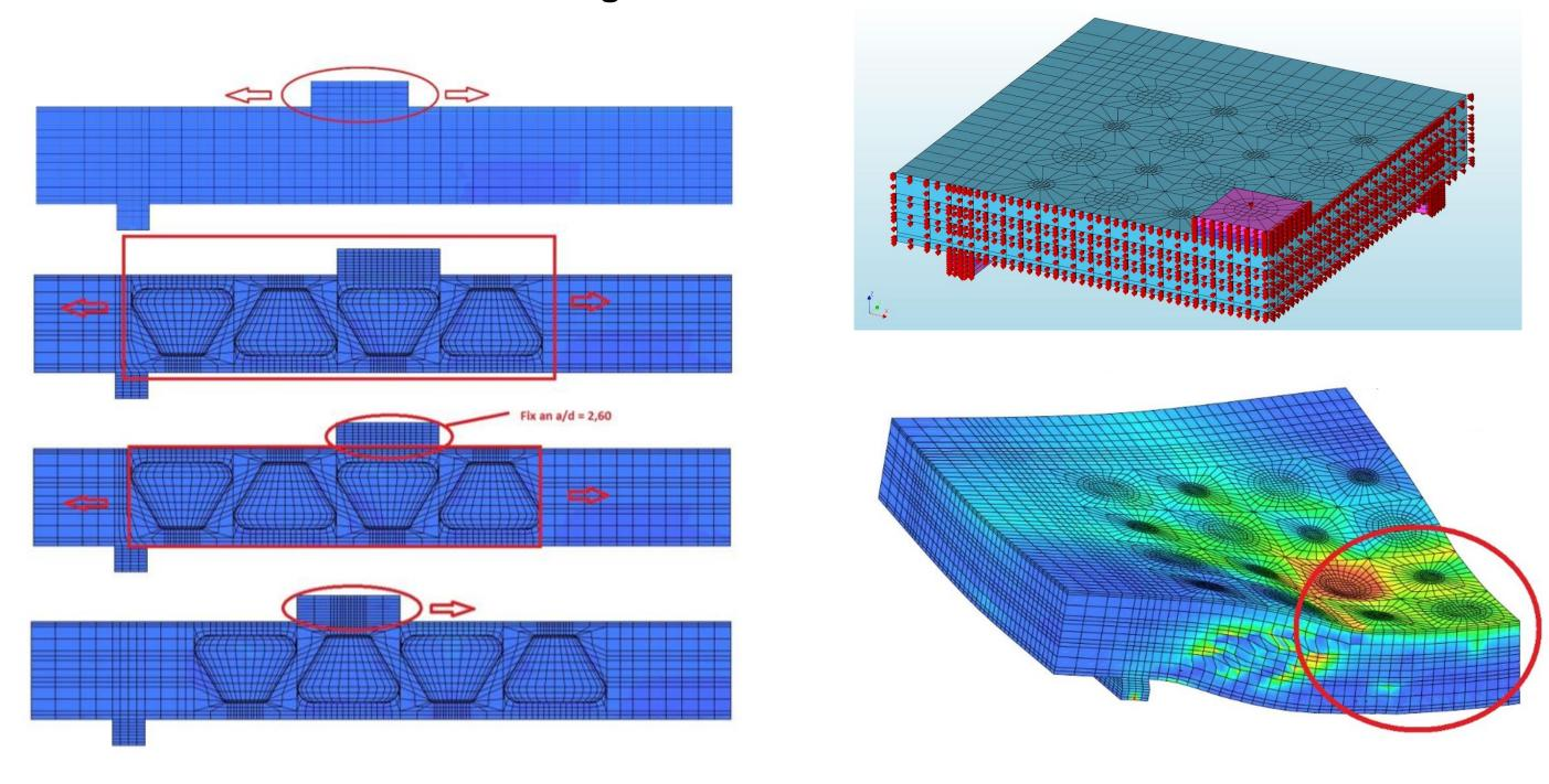
4.4 FEM-Analyse von Versuchen zum lokalen Durchstanzen bei zweiachsigen Hohlkörperdecken
